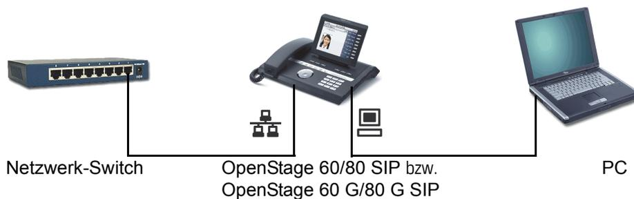
Durch diese Anschlussart sparen Sie jeweils einen Netzwerk-Anschluss des verwendeten Switches und benötigen bei entsprechender Anordnung weniger Netzwerk-Kabel bzw. nutzen kürzere Leitungswege.
