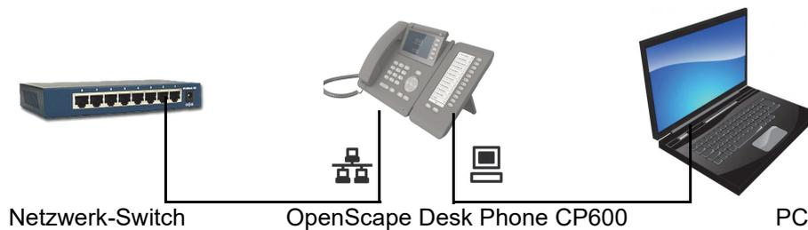
Durch diese Anschlussart sparen Sie einen Netzwerk-Anschluss des verwendeten Switches und nutzen kürzere Leitungswege.
