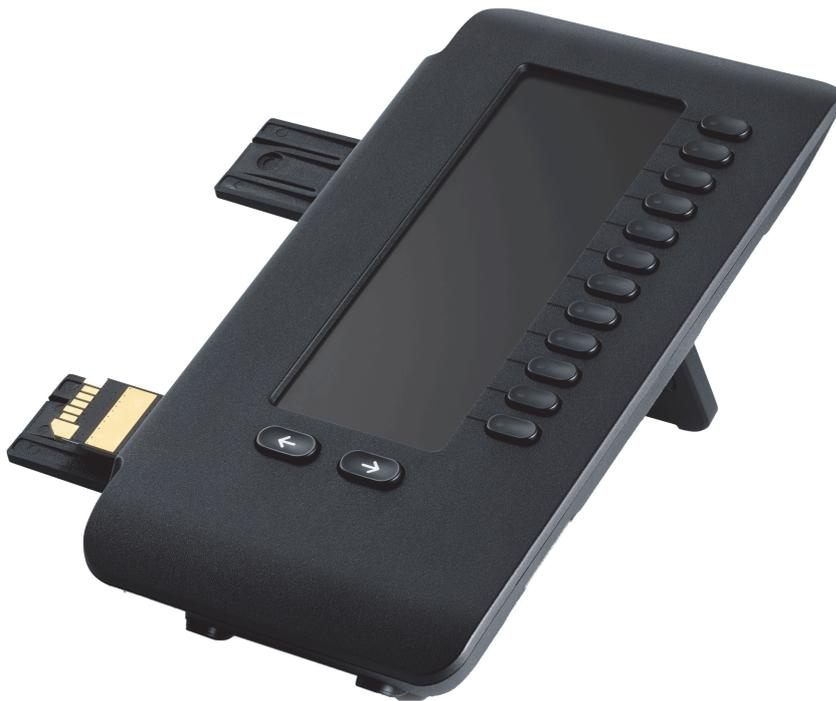
Die Abbildung zeigt das OpenScape Key Module 600. Sie können bis zu vier OpenScape Key Module 600 anschließen.
